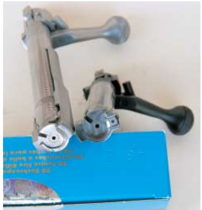
Winchester-Systeme im Vergleich: links das System 70 Classic pre 64 (Controlled Round Feed, CRF) mit langem Auszieher, rechts Controlled Round Push Feed (CRPF) ohne langen Auszieher.
