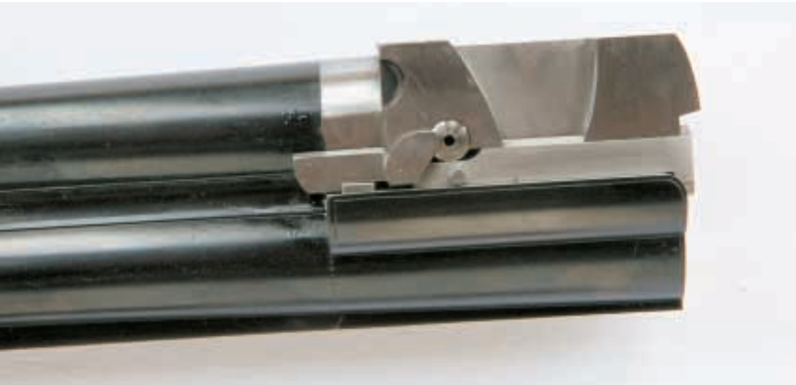
Sauber verarbeitete Basküle mit BOSS-Verriegelung und verdeckten Spannstangen.
