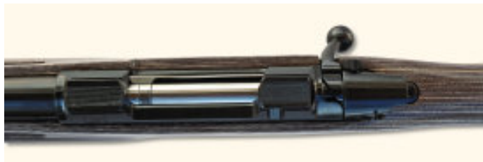
Das System der CZ 550 wird beim Schließen gespannt.
