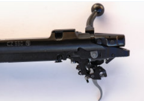
Der Kombi-Abzug hat einen Rückstecher, der ungestochen sehr trocken steht.
