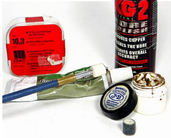
Bild links: Um einen Lauf von Geschossablagerungen zu befreien, sind die richtigen Reinigungsmittel notwendig. Bild rechts: Auch mit Polierpasten und Filz lassen sich Ablagerungen gründlich entfernen
